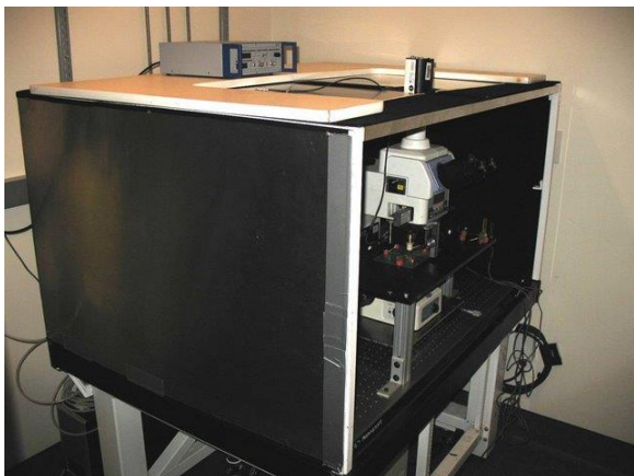
Рис. 2-а. Патч-кламп-стенд с клеткой Фарадея (Гарвард, Lichtman Lab)
