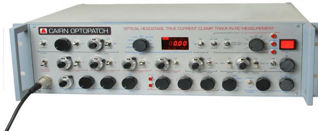
Рис. 3. Самобалансирующий фазочувствительный детектор - усилитель для локальной фиксации потенциала с оптической трансмиссией ("Optopatch").
