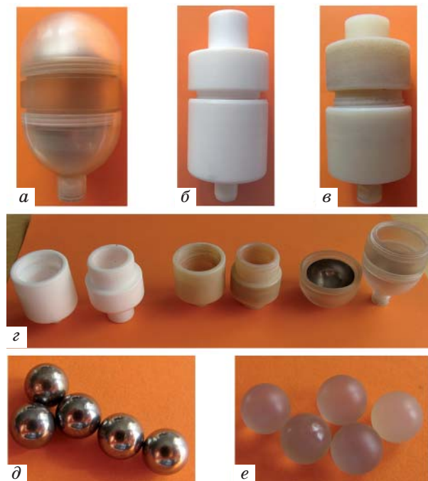
Рис. 2. Робочі камери і тіла: а — сталеву камеру вставлено в оболонку з поліметилметакрилату; б — фторопластова камера; в — капролактанова камера; г — камери у розібраному вигляді; д — сталеві робочі тіла; е — агатові робочі тіла
