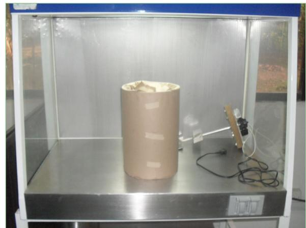
Figura-1: Diseño de Biorreactor artesanal.
