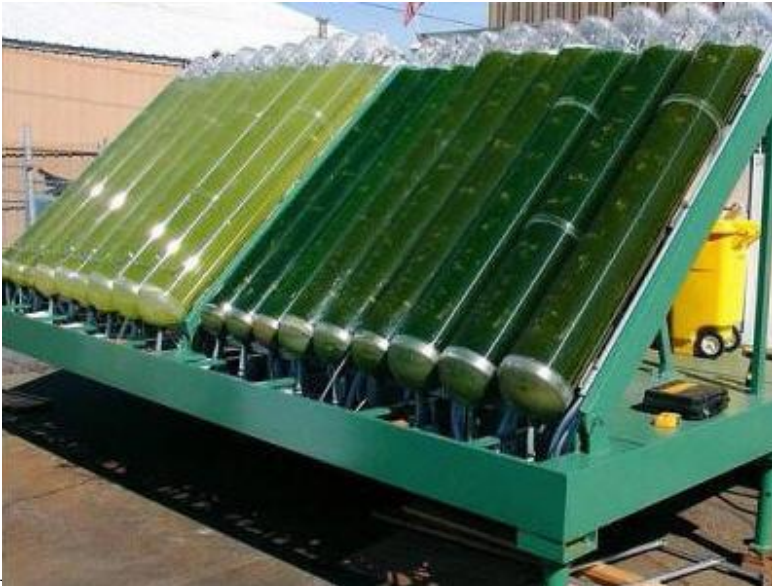
Рис. 9. установки на крыше здания для выращивания хлореллы
