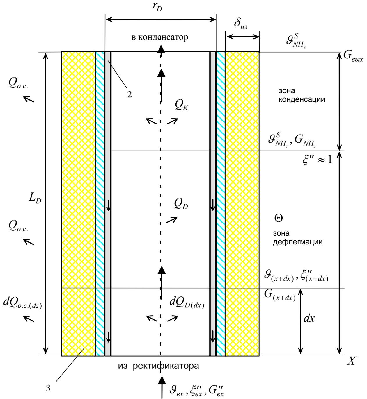
1 – стекающая флегма; 2 – стенка дефлегматора; 3 – теплоизоляционный кожух дефлегматора
