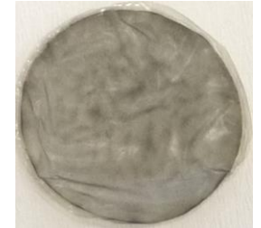
Şekil 8: Farklı kütlece yüzdelerde grafen oksit kullanılarak hazırlanan modifiye GO/PIM görüntüleri.
