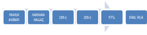
Şekil 1: İplik üretim prosesi şematik çizimi.
