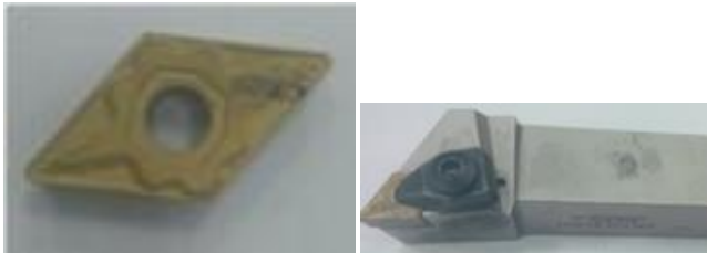
Şekil 1: Deney numunesi, kesici uç ve takım tutucu.
