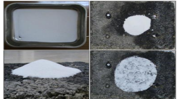
Şekil 25: Kum yama yönteminde kullanılan cam kürecikleri ve yöntemin uygulanışı.
