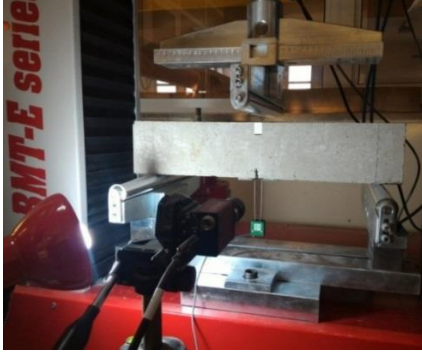
Şekil 5: Üç nokta eğilme deney ve ölçüm düzeneği.
