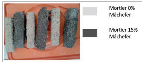
Fig. 12 - Fissurations du mortier dans l'acide sulfurique dues à la formation de produits expansifs
