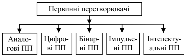
Рис. 3. Класифікація ПП видом вихідного сигналу
