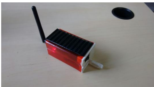
Figura 2 - Protótipo da Sonda Atmosférica Sem Fio (SASF) construído com material de baixo custo
