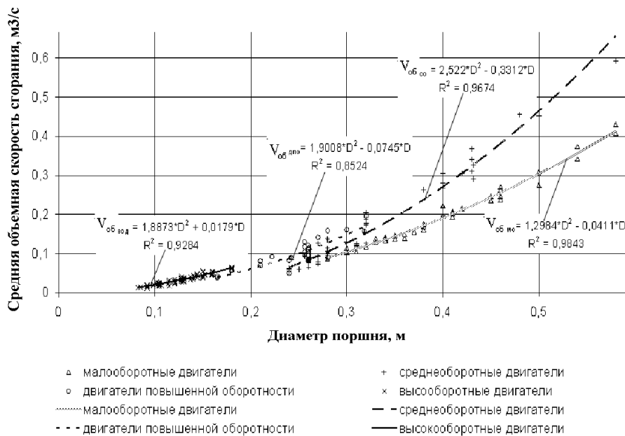
Рис. 1 – Изменение средней объемной скорости от диаметра поршня для различных типов дизелей (точки - опытные значения; кривые – расчетные значения)
