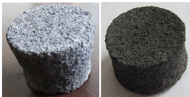
Рис. 5 – Дослідні зразки спечена в режимі СВС
