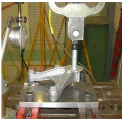
Fig. 3 – The experimental setup for testing on OX axis / Montajul experimental folosit pentru incercarea pe axa OX
