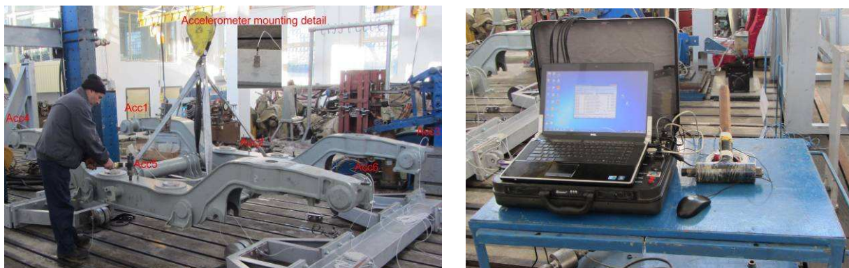
Fig. 2 - Experiments for modal identification of a bogie frame / Experimentari pentru identificarea modala a unei rame de boghiu
