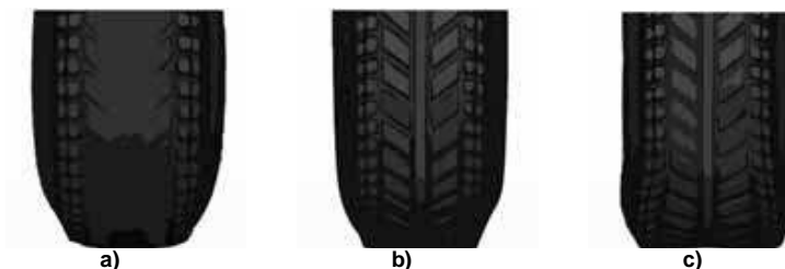
Fig. 2 - Influence of tyre inflation pressure on tyre deformation (Munro, 2008) / [8] Influența presiunii din pneu asupra modului de deformare a pneului
