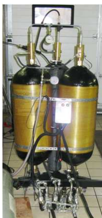
Fig. 3 – Realized high pressure compressor system of gaseous fuel / Izveidotā gāzveida degvielas augstspiediena kompresora sistēma
