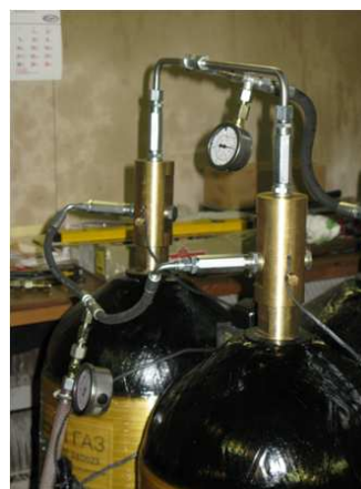
Fig. 3 – Realized high pressure compressor system of gaseous fuel / Izveidotā gāzveida degvielas augstspiediena kompresora sistēma
