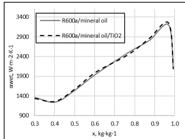
Рисунок 6 – Зависимость локального коэффициента теплоотдачи рабочих тел со стороны смоченной поверхности трубы  $\alpha_{wet}$  от степени сухости  $x$  на различных участках испарителя при массовой скорости  $\dot{m} \approx 17.1 \text{ кг м}^{-2} \text{ с}^{-1}$  и тепловом потоке  $q \approx 4930 \text{ Вт/м}^2$ .
