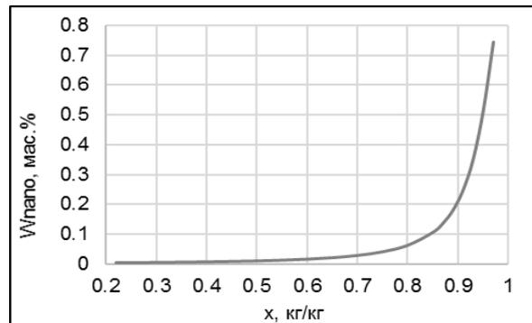
**Рисунок 4** - Зависимость концентрации примесей масла -  $W_{oil}$  и наночастиц  $\text{TiO}_2$  -  $W_{nano}$  в растворе R600a/минеральное масло от степени сухости рабочего тела в испарителе при массовой скорости  $m \approx 17,1 \text{ кг/м}^2\text{с}$  и тепловом потоке  $q \approx 4930 \text{ Вт/м}^2$ .
