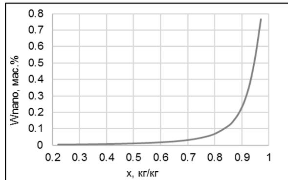
**Рисунок 3** - Зависимость концентрации примесей масла -  $W_{oil}$  и наночастиц  $\text{TiO}_2$  -  $W_{nano}$  в растворе R600a/минеральное масло от степени сухости рабочего тела в испарителе при массовой скорости  $m \approx 14,3 \text{ кг/м}^2\text{с}$  и тепловом потоке  $q \approx 3550 \text{ Вт/м}^2$ .
