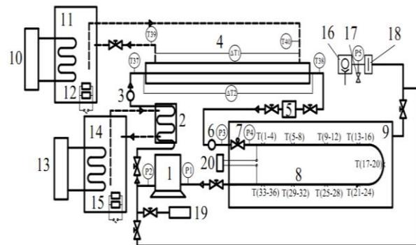
**Рисунок 1** – Принципиальная схема экспериментальной установки для исследования теплообмена при кипении рабочего тела в трубе:
