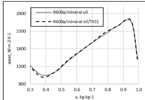
Рисунок 5 – Зависимость локального коэффициента теплоотдачи рабочих тел со стороны смоченной поверхности трубы  $\alpha_{wet}$  от степени сухости  $x$  на различных участках испарителя при массовой скорости  $\dot{m} \approx 14.3 \text{ кг м}^{-2} \text{ с}^{-1}$  и тепловом потоке  $q \approx 3550 \text{ Вт/м}^2$ .
