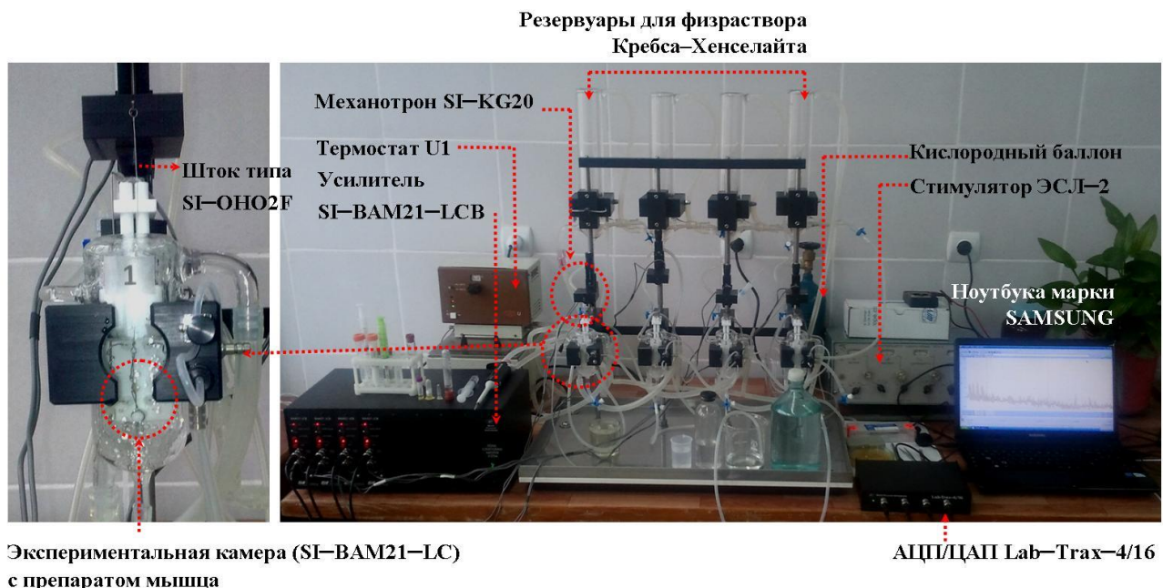
Рис. 1. Установка для для фармакологического исследования изолированных папиллярной мышцы в условиях in vitro (WPI, World Precision Instruments, Inc. USA). Объяснение в тексте.
