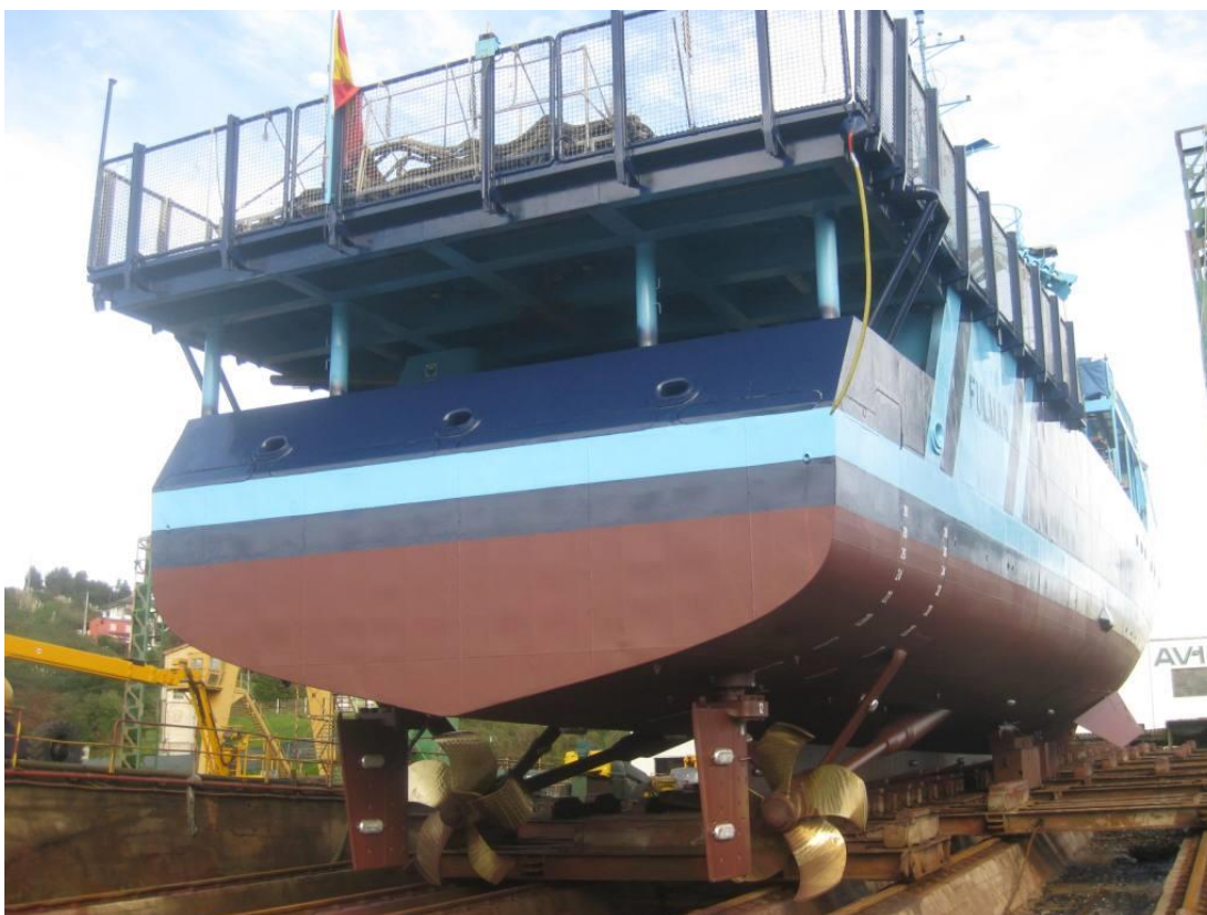
Рис. 7. Винторулевой комплекс В.О.Е. “Fulmar”
