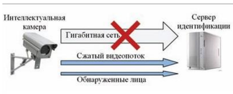
Рис. 4. Применение интеллектуальных камер и схема обработки данных
