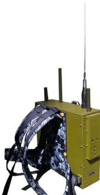
Рис. 3. Ранцевый блокиратор радиовзрывателей «Пелена-6Р», диапазон частот создаваемой помехи 20 – 1000 МГц, выходная мощность 64 Вт
