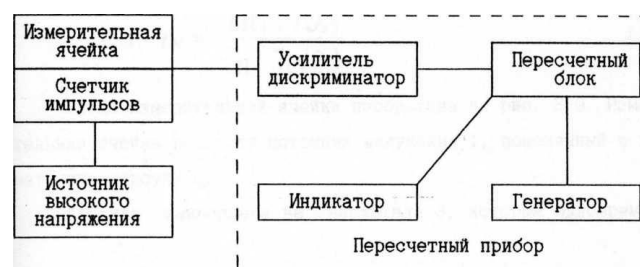
Рисунок 1 - Схема установки для измерения локального значения объемной плотности.
