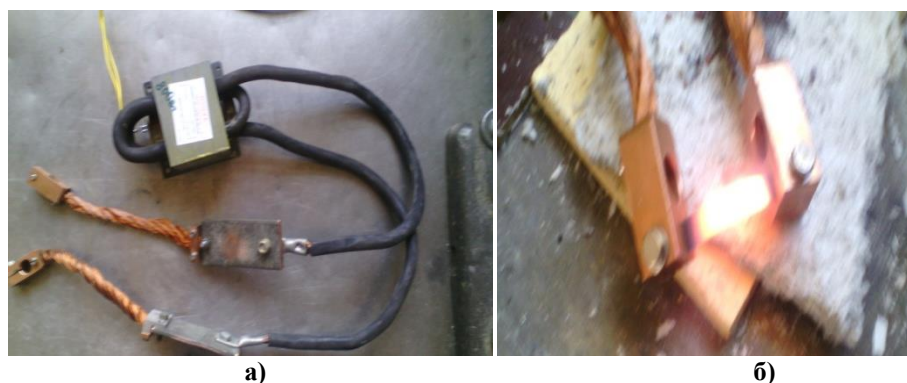
Рисунок 1 - а) Установка для проведения КТО; б) Процесс контактной термической обработки, стали X18H15.
