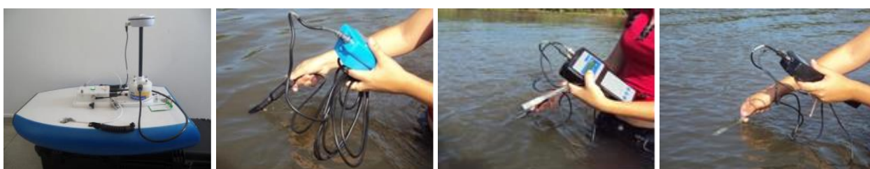
Figura 2 - (A) Medidor acústico Doppler de vazão- ADP; (B) Medição do Oxigênio Dissolvido; (C) Medição de Temperatura e Ph e (D) Medição de CE. Fonte: Autor, 2013.
