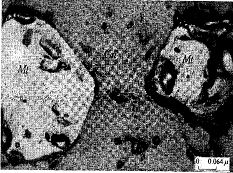
Şekil 8. Gang içinde ve gang tarafından ornatılmış özşekilli manyetit (I. Nikol) Mt: Manyetit, Gn: Gang
