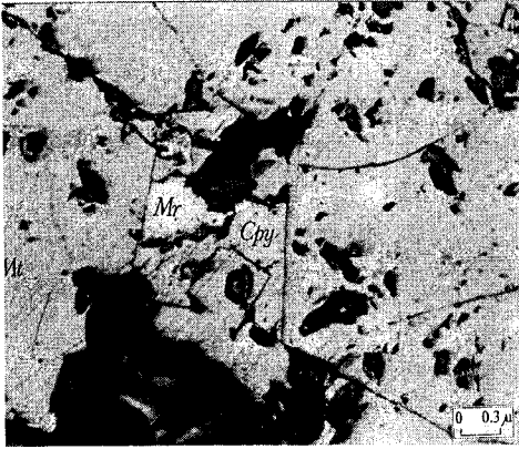
Şekil 20. Manyetit kalkopirit arasındaki düz sınırlar (I. Nikol) Mt: Manyetit, Cpy: Kalkopirit, Mr: Markazit
