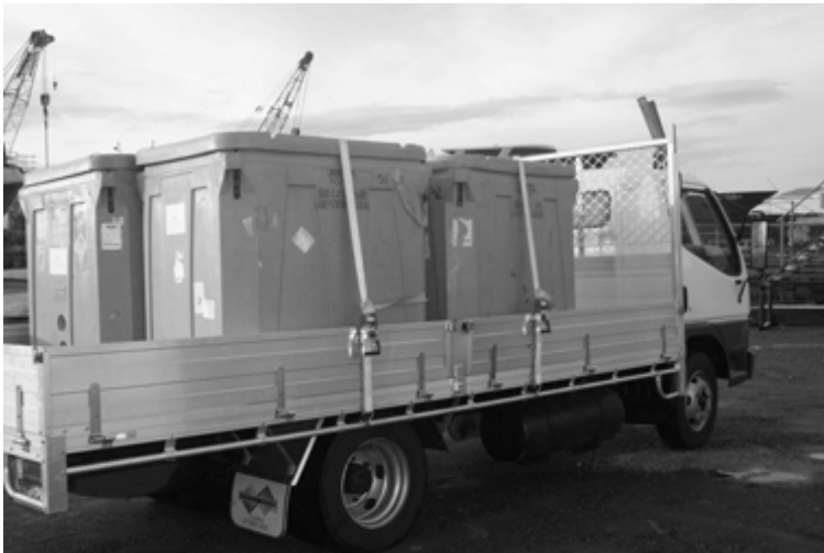
Рис. 5. Автономні живорибні контейнери на шасі бортової вантажівки
