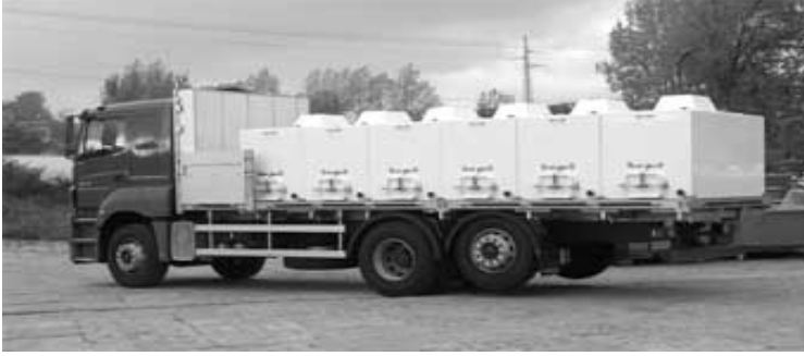
Рис. 3. Бортовий вантажний автомобіль із встановленими ізоtermічними контейнерами для перевезення живої риби [5]
