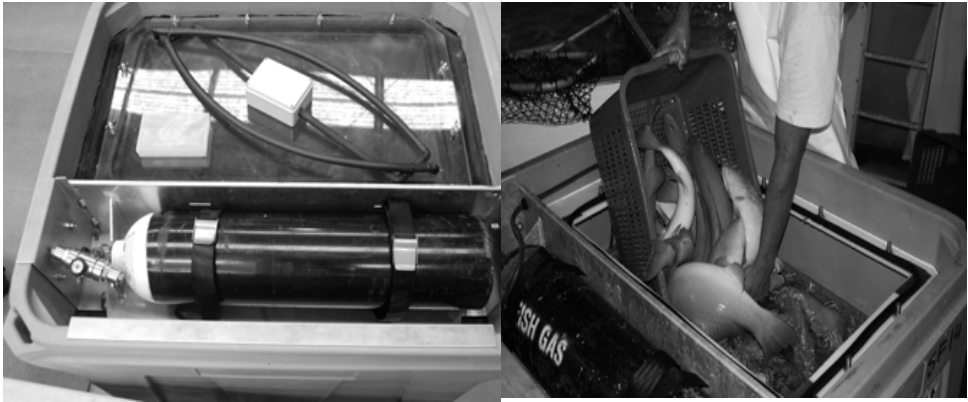
Рис. 4. Живорибні контейнери з автономною системою аерації [5]
