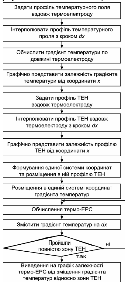
Рис. 2. Алгоритм обчислення залежності термо-ЕРС E від положення температурного поля T(x) відносно зони термоелектричної неоднорідності \alpha_x .
