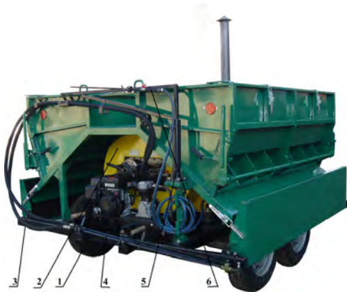
Рис. 1. Загальний вигляд бітумо-щебеневого агрегату: 1 – рама, 2 – цистерна-термос, 3 – рукави подачі бітуму, 4 – пістолет бітумний, 5 – куліса поворотна, 6 – пістолет повітряний
