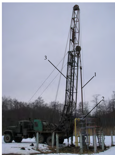
Рис. 3. Фонтанна арматура свердловини № 241 з лубрикатором і підіймальна установка під час опускання зонда.
