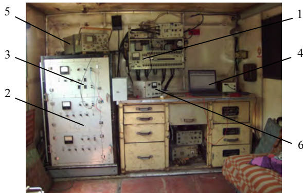
Рис. 5. Апаратура для настройки і запису сигналів з вібродатчиків.
