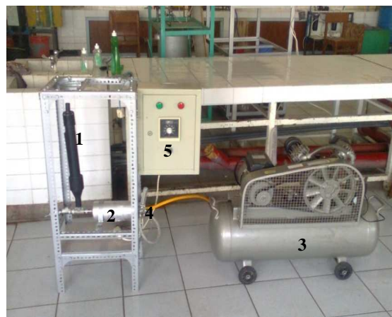
Gambar 1. Alat pengering unggun terfluidakan (1) fluidized bed, (2) heater, (3) kompresor, (4) valve, (5) sistem kontrol
