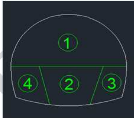
شکل ۸ شماتیک روند اجرایی حفاری تونل
