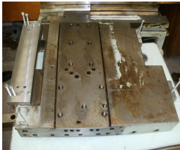
Рис. 1 – Установка выставочных и монтажных винтов на суппорте
