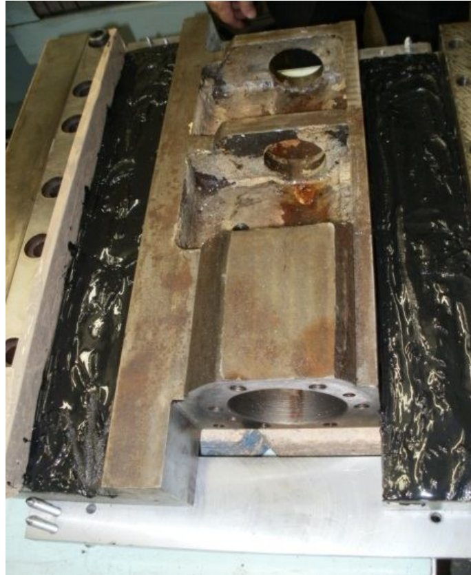
Рис. 2 – «Моглайс» нанесен на направляющие суппорта
