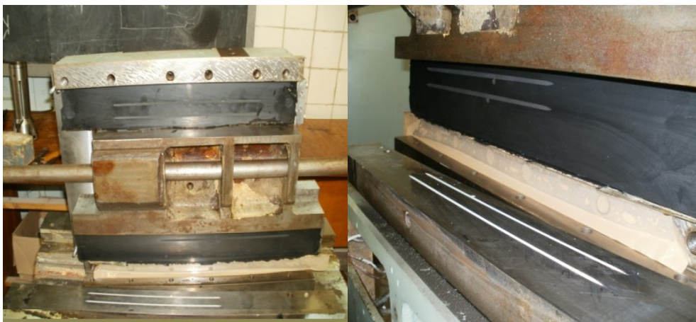
Рис. 3 – Сформированные направляющие на суппорте. Суппорт повернут на 90°
