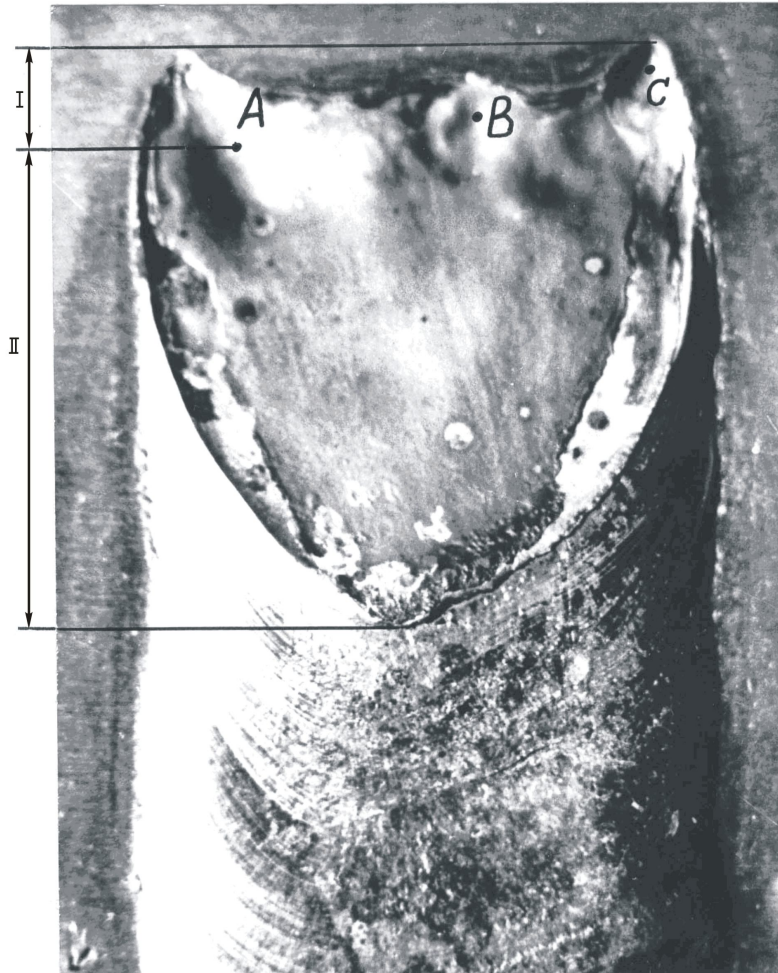
Рис. 1 – Кратер сварочной ванны после удаления расплавленного металла (пояснения даны в тексте)
