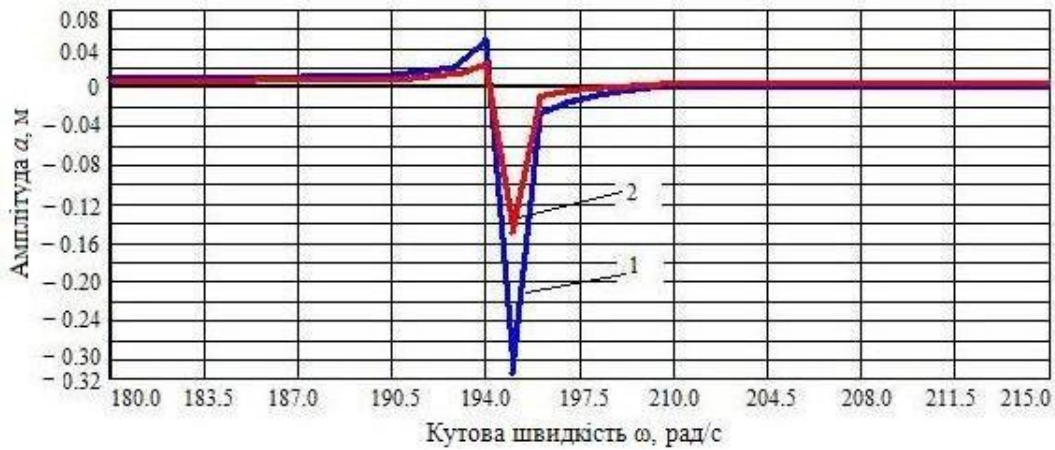
Рис. 8 – Графіки залежностей амплітуди горизонтальних коливань від кутової швидкості ротору \omega : 1 – e = 0,001 м; 2 – e = 0,0005 м
