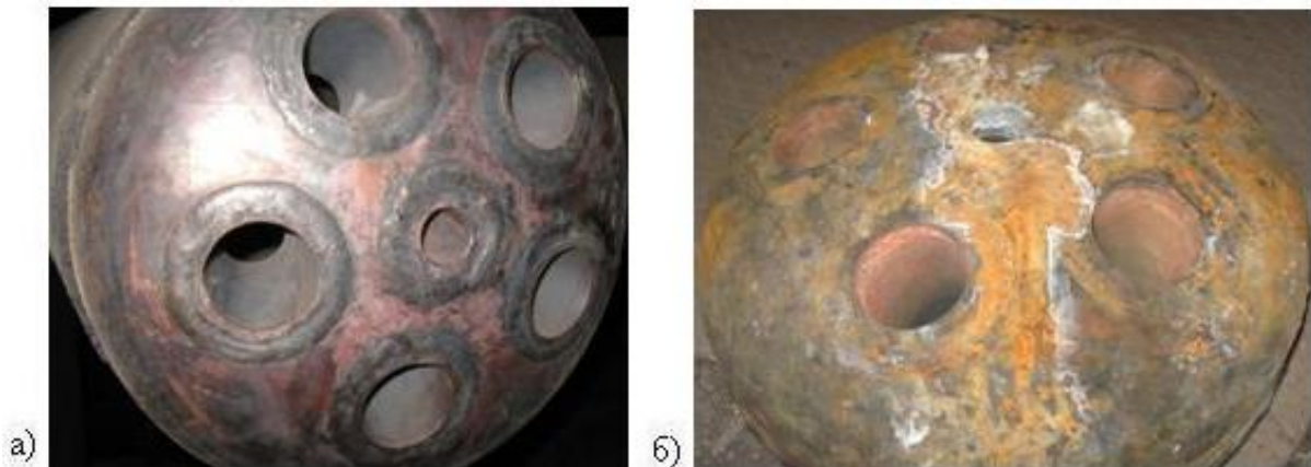
Рис. 3 – Наконечник кислородной фурмы модернизированной конструкции в период испытаний: а) – после установки на фурменный ствол; б) – снятый с фурмы после 329 плавков
