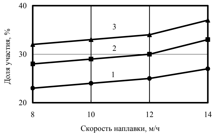
Рис. 2 – Доля участия основного металла в первом наплавленном слое в зависимости от скорости наплавки: 1 – 60×0,5 мм; 2 – 47×0,7 мм; 3 – 30×1,0 мм
