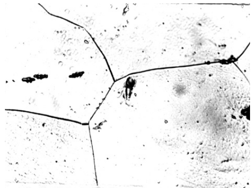
Рис. 3 - Мікроструктура горячекатаного підкату після гартування з 1100°C – 1 хв/мм, \times 1000
