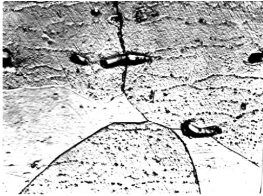
Рис. 2 - Мікроструктура горячекатаного підкату після гартування з 1000°C – 1 хв/мм, \times 1000
