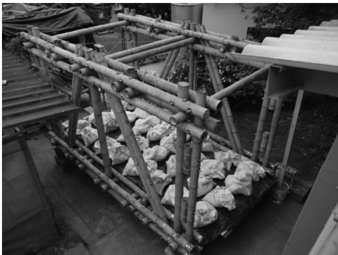
Figura 15. Distribución de la fuerza aplicada durante las pruebas de carga realizadas a cada uno los módulos
