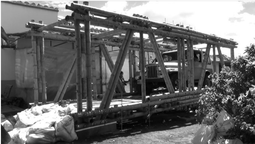
Figura 12. Prueba de carga con un vehículo liviano, peso aproximado 18 kN
