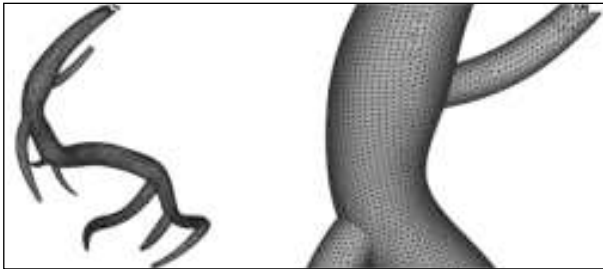
Рис. 5. Наложение расчетной сетки на модель коронарных артерий
