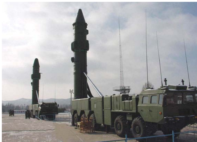
Dve varijante rakete CSS-5/DF-21 na lansirnim oruđima. Raketa na desnoj strani trebalo bi da je DF-21C, dok je raketa na levoj strani verovatno „nova” verzija pod nazivom DF-21D
