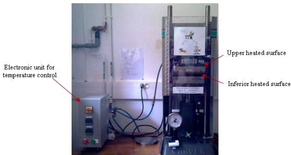
Fig. 2 - Compression moulding machine used to form the test bars / Masina de formare prin comprimare utilizata la realizarea barelor de testare
