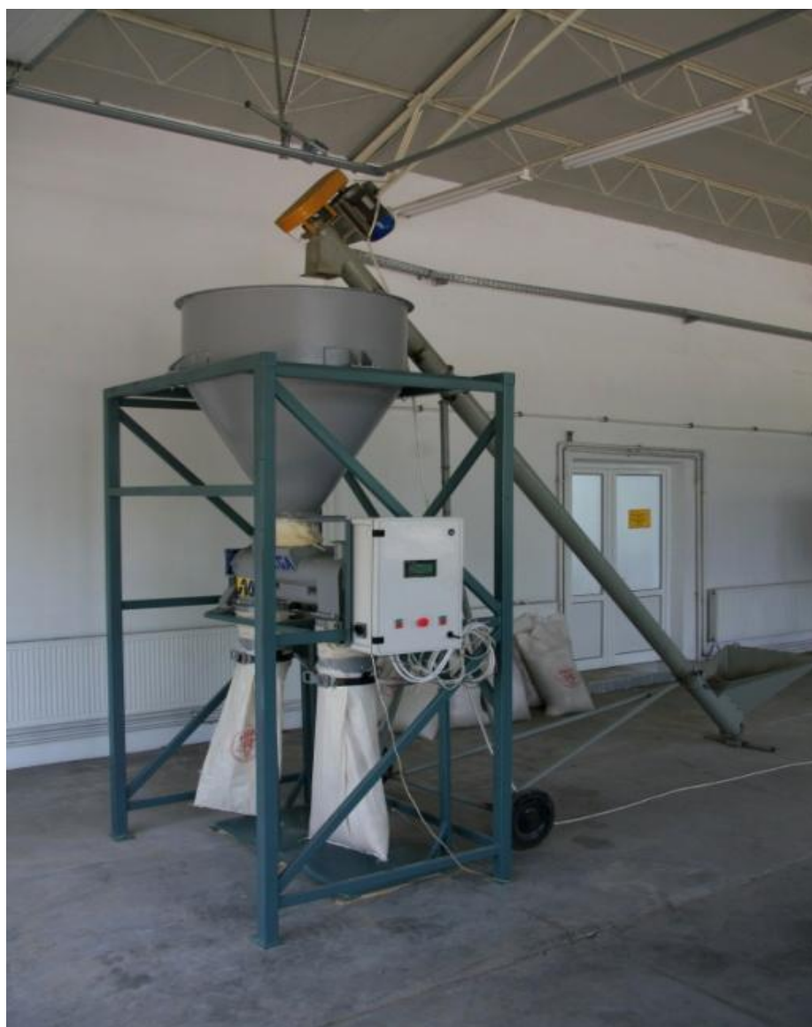
Fig. 1. – Equipment for weighing and automated management– EWAM - Overview / Echipament pentru cântărire și gestionare automată ECGA - vedere generală
