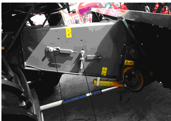
chains stretching system / lifting system of conveyor fore axle / sistem de întindere lanțuri / sistem de ridicare ax anterior transportor
