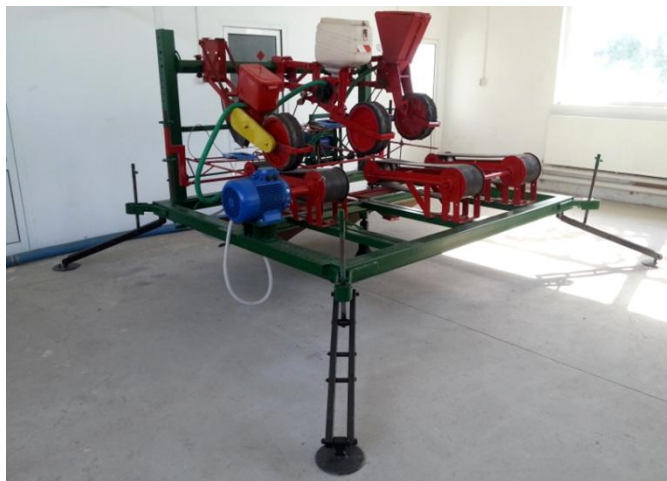
Fig. 1 - Bench SPS-3 for sowing precision machines testing / Standul SPS-3 pentru testarea secțiilor semănătorilor de precizie
