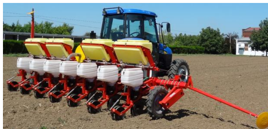
Fig. 1 - Sowing machine for hoeing plants with fertilizing device / Semănătoare pentru plante prășitoare cu fertilizator SPF8M
