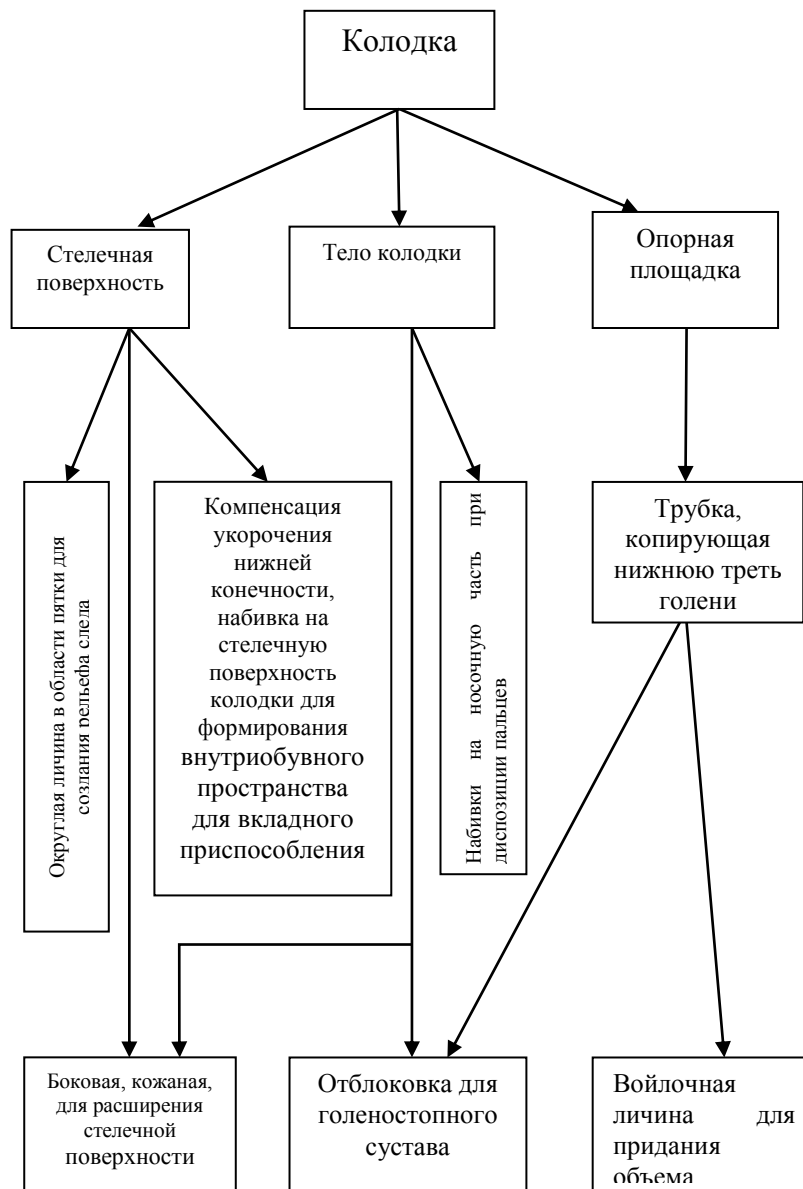
Рисунок 4- Классификация конструктивных элементов по месту расположения на колодке.
