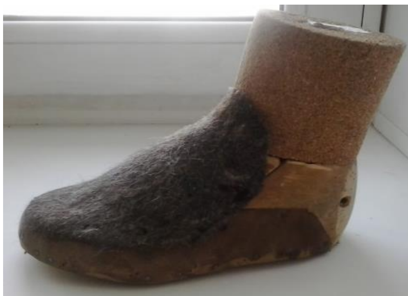
Рисунок 3 – Колодка на паралитическую стопу (на основе аппаратной).
