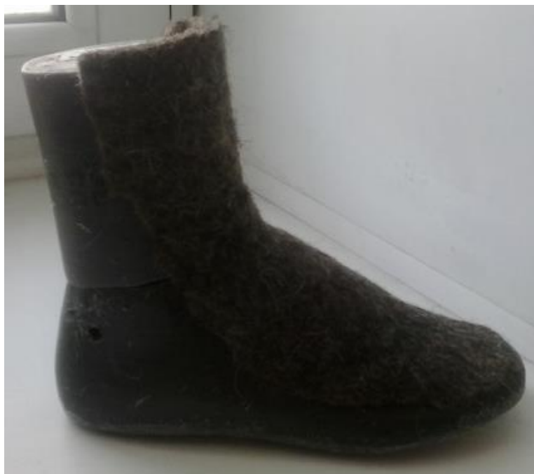
Рисунок 2- Берцовая колодка с войлочной личиной.
