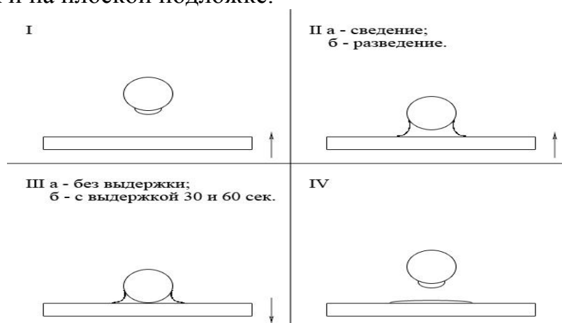
Рисунок 1 - Схемы расположения модельных частиц на разных стадиях проведения экспериментов
